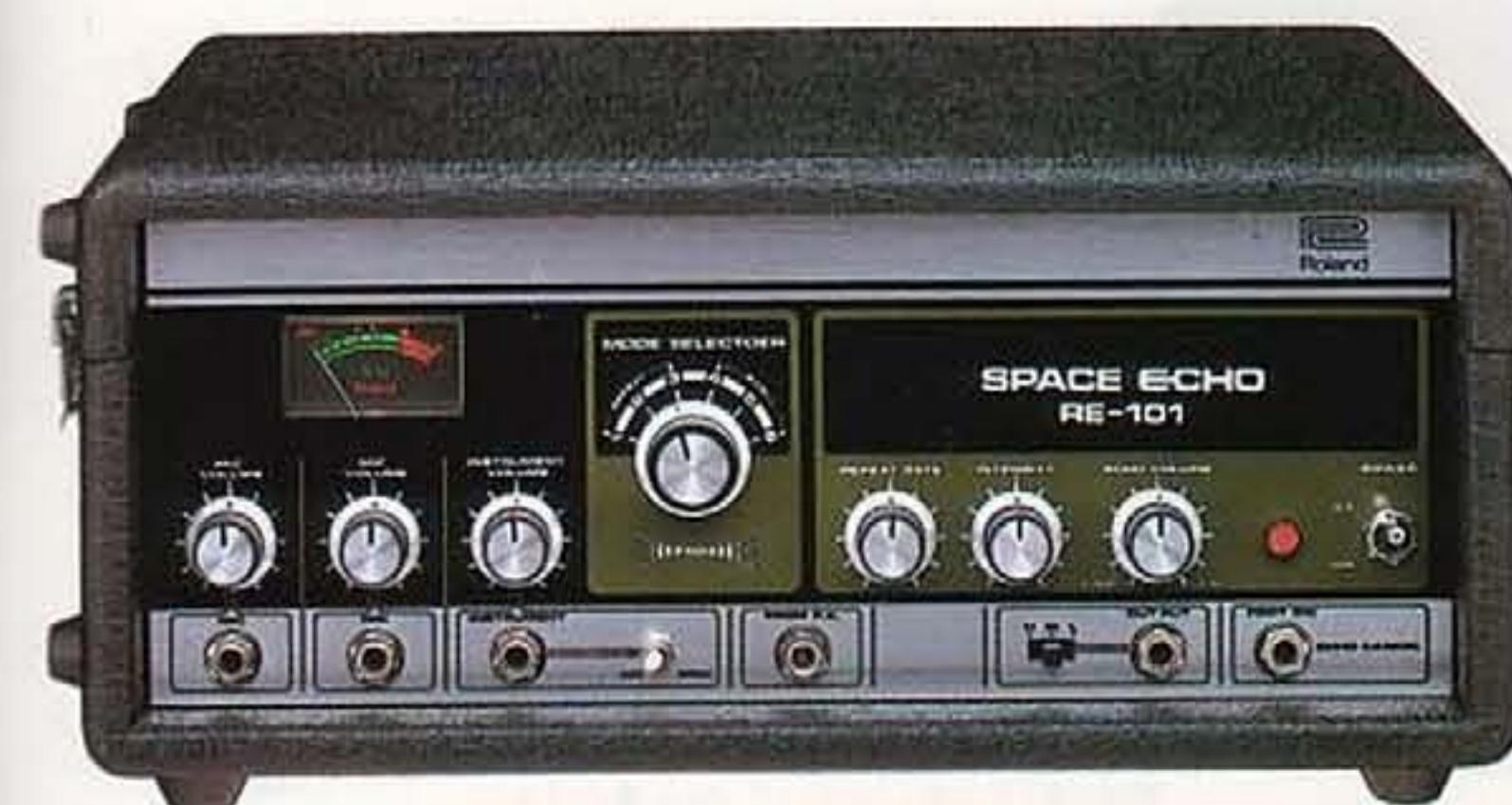
6種のモード、リピート・レイト、インテンシティ、エコー・ボリュームのコントロール類を装備。3チャンネル(マイク2、インストルメント1)のミキシング、マイク併用時に便利なインストルメント・チャンネルのエコー・キャансセルができるなど、エコーチャンバーの原点を追求したモデルです。メカニズムは、RE-201と同じフリーランニング方式のテープ走行、ブランシング・レス・サーボモーター、ダ
