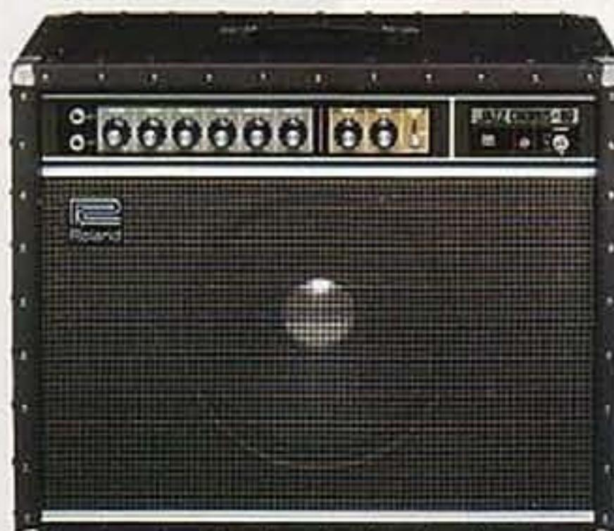
●出力: 60W(R.M.S.) • スピーカー: 30cm×1 • インピーダンス: 8Ω • チャンネル: 1チャンネル • インプット・ジャック: ハイ、ロー • コントロール: ボリューム、トレブル、ミドル、ベース、ディストーション、リバーブ、ピブラート・スピーカー、ピブラート・ゲート、コラス/ピブラート切替スイッチ、電源スイッチ・フットスイッチ: コラス/ピブラート、ディストーション、リバーブ • アウトプット・ジャック: 外部スピーカー用8Ω、ラインアウト・ACアウトレット • 消費電力: 48W • 外形寸法: 608(W)×500(H)×233/263(D)mm • 重量: 20kg • 付属品: ピニール・カバー
