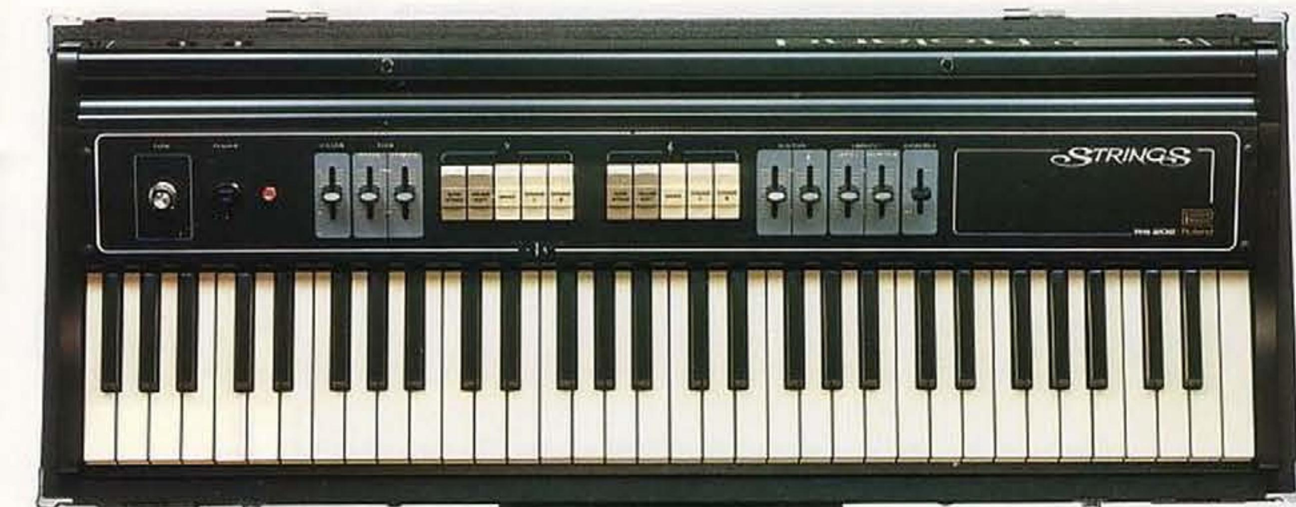
つやのある美しいストリングス・サウンド(弦楽合奏音)と、豊かな音色のプラス・サウンド(管楽合奏音)を出すことのできる表現力に富んだ61鍵ドケールの電子キーボードです。特にロックやジャズのコンボ演奏に、今までにはない厚みと幅を与えます。ストリングスとプラスはそれぞれトーン・コントロールで音色調節ができ、ピブラート・ゲイズとピブラート・ダイレイタイムを加えることによりピブラートの効果の深さ、かかり始めるまでの長さを自由に調節することができます。立ち上がり、減衰に変化をつけるスロー・アタック、サステイン、オーバーハンド、ピブラート、ピブラート・ゲイズ、ピブラート・ゲイズ・ダイレイタイム ●アウトプット・ジャック ●電源スイッチ ●バイロットランプ ●消費電力: 15W ●外形寸法: 910(W)×182(H)×350(D)mm ●重量: 17kg ●付属品: 演奏立て, 2.5m接続コード
