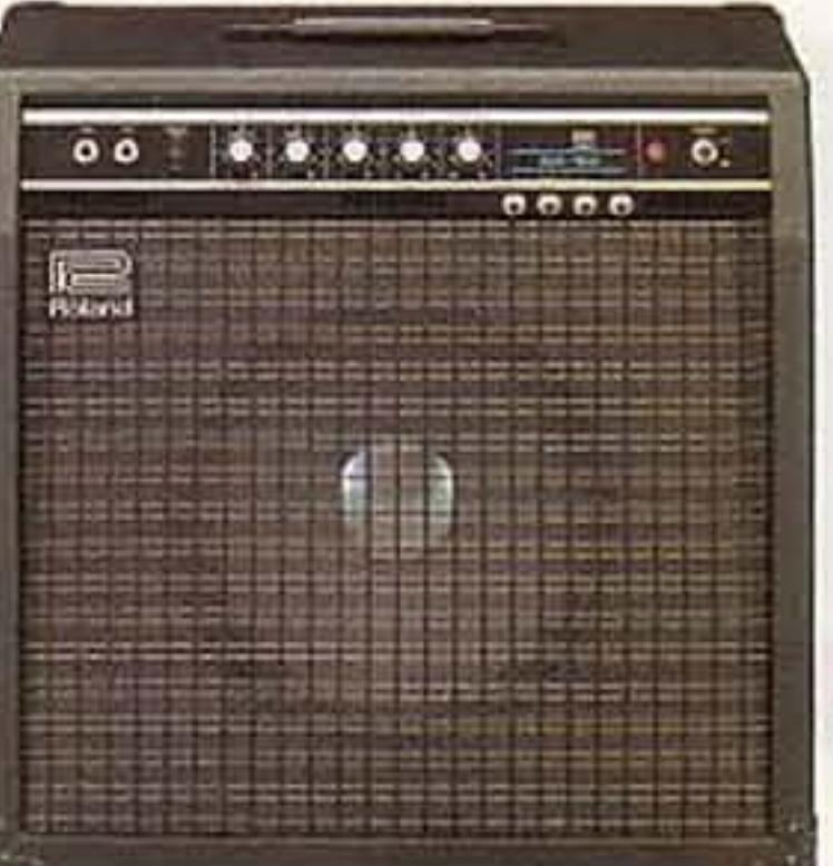
●出力: 120W(R.M.S.) • スピーカー: 30cm×2 • インピーダンス8Ω • チャンネル: 1 • 入力端子: ハイ、ロー、ライン • コントロール: オーバードライブ(ON/OFFスイッチ付), トーン, トレブル, ミドル, ベース, リバーブ, フットスイッチ・ジャック: ブースター, リバーブ, ディストーション, ブライ特(ON/OFFスイッチ付), リバーブ, マスター・ボリューム, 電源スイッチ • イコライザー・コントロール: 6素子±12dB(センタークリック・スライド・ボリューム)100Hz, 300Hz, 600Hz, 1.2KHz, 2.5KHz, 5KHz, レベル, ON/OFFスイッチ • フットスイッチ・ジャック: オーバードライブ、リバーブ、イコライザー • 出力端子: ヘッドホン用(8Ω), ラインアウト • ACアウトレット • 消費電力: 110W • 外形寸法: 707(W)×604(H)×291(D)mm • 重量: 26kg • 付属品: ピニール・カバー
