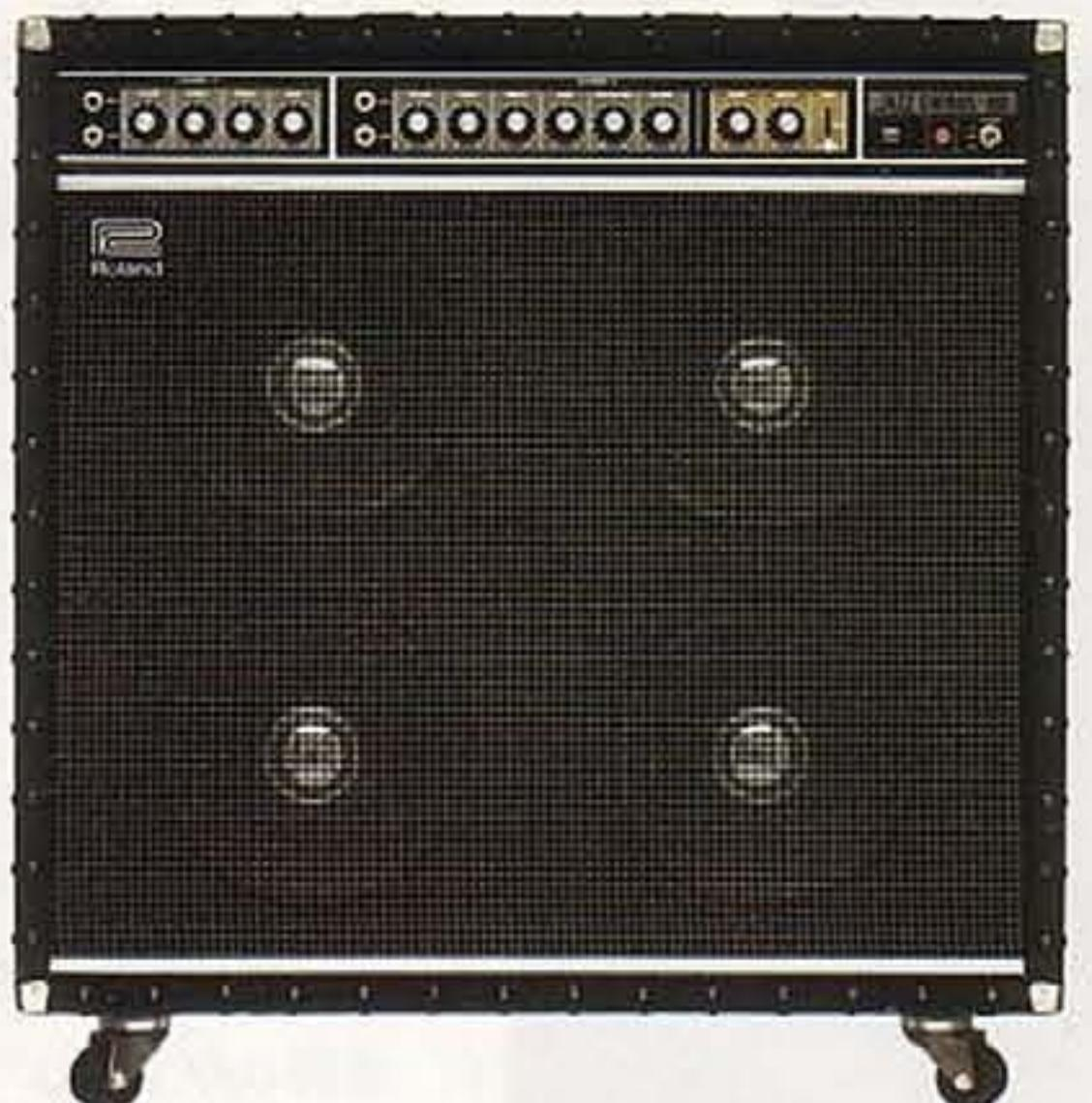
●出力: 120W(R.M.S.) • スピーカー: 25cm×4 • インピーダンス: 8Ω • チャンネル: 2チャンネル(ノーマル、エフェクト) • インプット・ジャック: ハイ、ロー • コントロール: ボリューム、トレブル、ミドル、ベース、ディストーション、リバーブ、ピブラート・スピーカー、ピブラート・ゲート、コラス/ピブラート切替スイッチ、電源スイッチ・フットスイッチ: コラス/ピブラート、ディストーション、リバーブ • アウトプット・ジャック: 外部スピーカー用×2(8Ω)、ラインアウト・ACアウトレット • 消費電力: 120W • 外形寸法: 770(W)×634(H)×270(D)mm • 重量: 35kg • 付属品: ピニール・カバー
